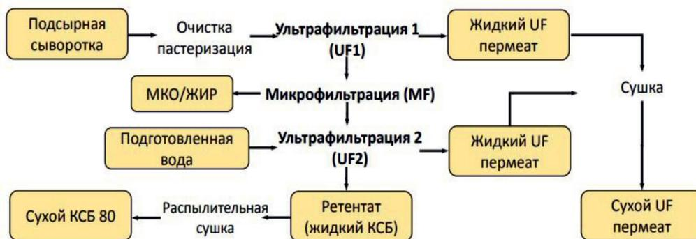
Исходный, промежуточные и конечные продукты при переработке подсырной сыворотки методами ультра- и микрофилтрации с получением сухого концентрата сывороточного белка [2]
