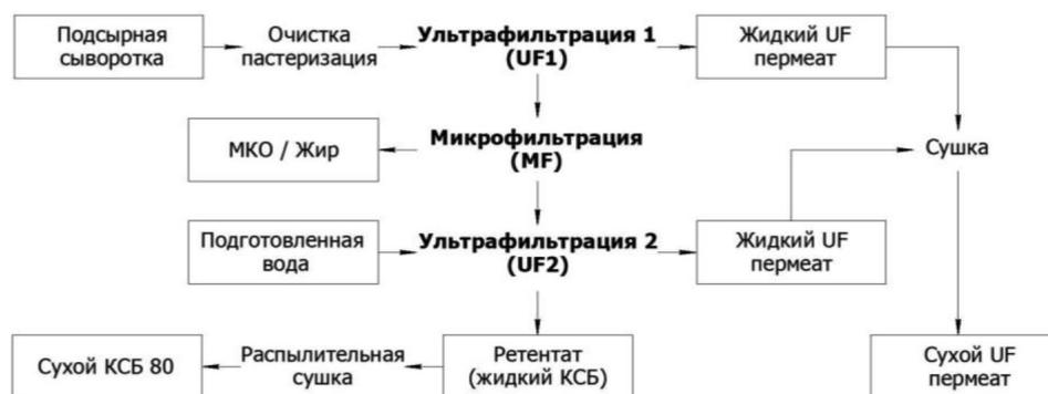
Блок-схема получения сухих фракций подсырной сыворотки при мембранном фракционировании [6]
