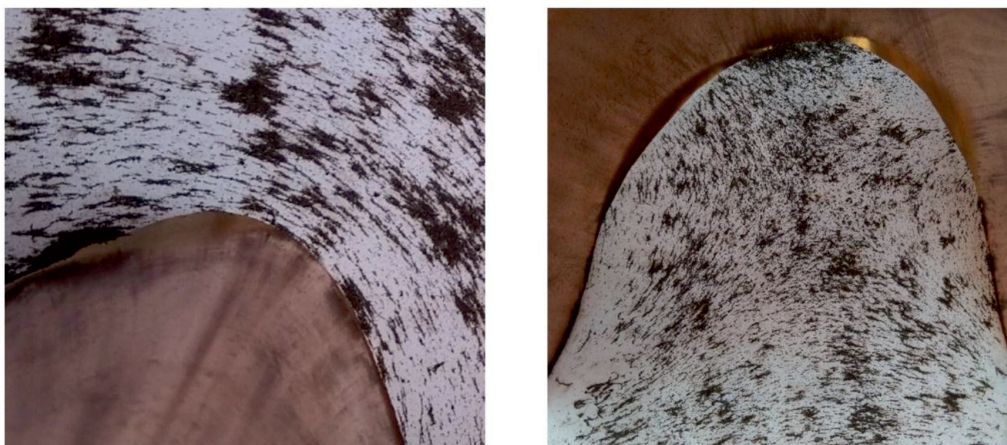
Рис. 3 Фотографии железных опилок вокруг листового проводника с током. Внешняя сторонагиба листа (слева). Внутренняя сторонагиба листа (справа)
