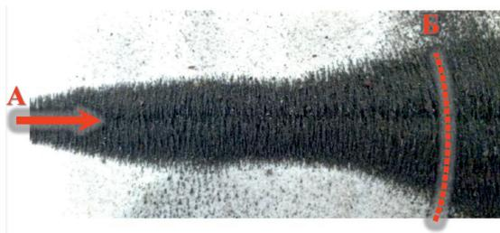
Рис. 1. Искривления силовых линий железными опилками над горизонтальным проводником.
