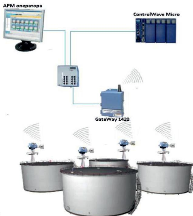
Рис. 1. Общая схема построения системы измерительной МЕТРАН ГСUR-10
