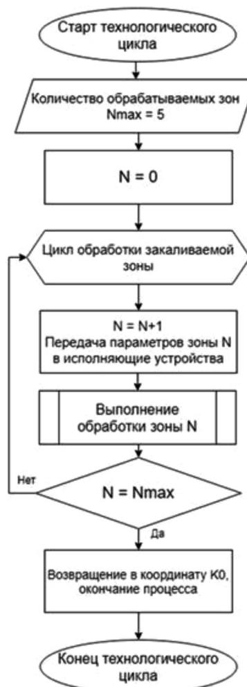
Алгоритм цикла выполнения многозонного технологического процесса индукционной термообработки деталей
