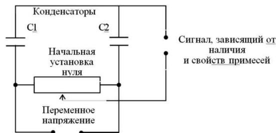
Рис. 2. Схема устройства для измерения величины и скорости отклонения диэлектрических проницаемостей нового и эксплуатируемого смазочного механизма
