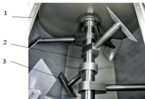
Рис. 2. Лопастной горизонтальный смеситель (вид изнутри): 1 – корпус; 2 – вал; 3 – лопасти
