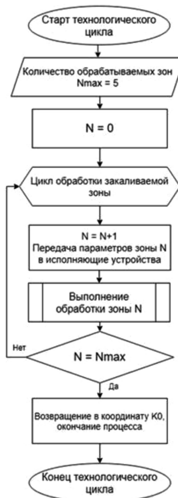
Алгоритм цикла выполнения многозонного технологического процесса индукционной термообработки деталей
