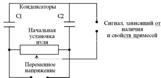
Рис. 2. Схема устройства для измерения величины и скорости отклонения диэлектрических проницаемостей нового и эксплуатируемого смазочного механизма
