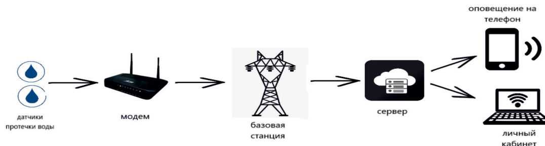
Рис. 1. Структурная схема передачи данных протечки
