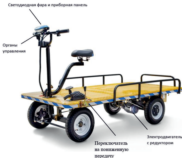
Устройство платформенной электрической тележки RuTrike
