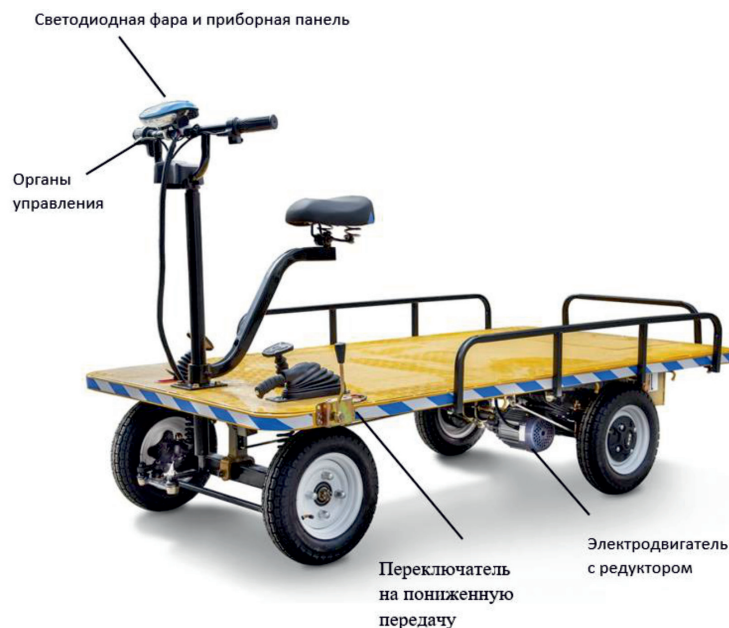
Устройство платформенной электрической тележки RuTrike
