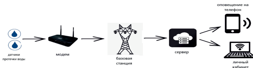
Рис. 1. Структурная схема передачи данных протечки
