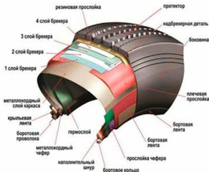
Рис. 1. Строение шины [1]
