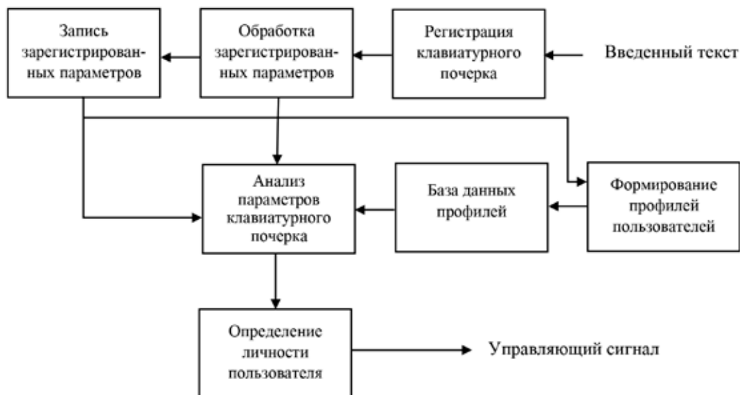
Рис. 1. Последовательность функционирования системы аутентификации пользователей на основе клавиатурного почерка
