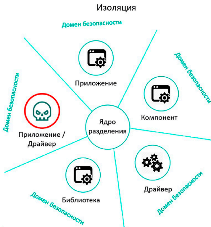
Рис. 2. Пример разделения компонентов системы в KasperskyOS на домены безопасности [1]
